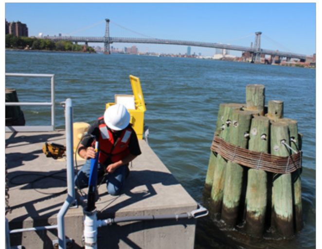
Thiết bị chất lượng nước đa thông số EXO2 của YSI được cài đặt bởi kỹ thuật viên hiện trường tại vị trí quan trắc ở New York.
