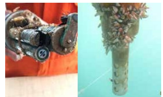
Cần gạt trung tâm YSI EXO Central Wiper và bộ bảo vệ bằng đồng để tối thiểu hóa bám bẩn sinh học trên cảm biến
