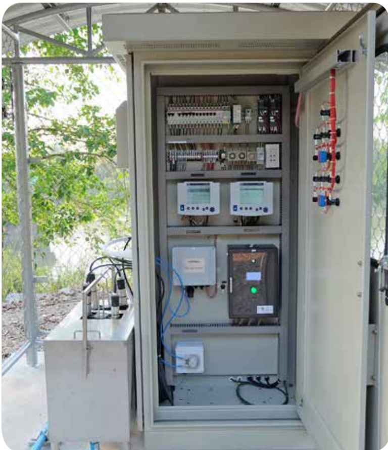
Bên trên: Là một trong 16 trạm quan trắc nước sông mới được lắp đặt ở khu vực đô thị của Bangkok. Nó được trang bị một căn nhà để đảm bảo các thiết bị đo lường không bị phá hoại và trộm cắp.
