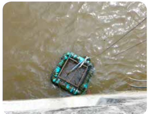
Địa điểm lấy mẫu nước của trạm đo. Mẫu nước được lấy bằng máy bơm chìm, chúng được một cái lồng kim loại đặt dưới mặt nước ngăn cản các mảnh vụn và giúp tránh tác nghẽn. Khu vực lấy mẫu được trang bị một cái phao để có thể lấy được mẫu nước khi mực nước dao động mạnh.
