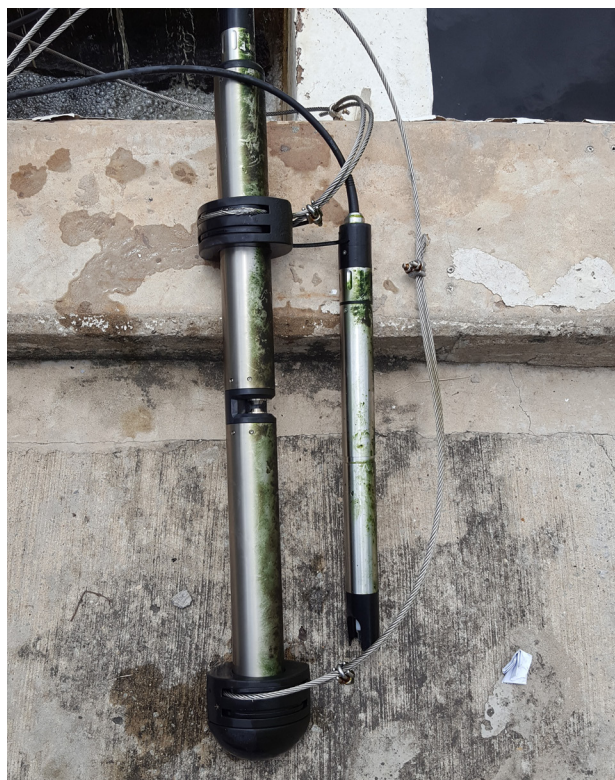
Hình 6 – Ảnh (tại NMXLNT Vĩnh Lộc) của cảm biến quang phổ (mặt trước) và cảm biến pH (nền) sử dụng để đo COD, TSS và pH tương ứng.
